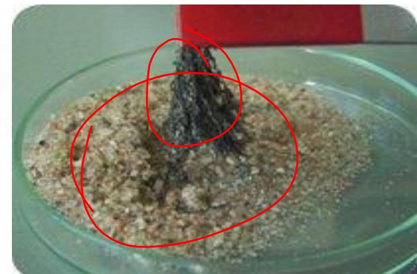
**Separação magnética:** Separa misturas do tipo sólido-sólido nas quais um dos componentes tem propriedades magnéticas e é atraído por um ímã.
