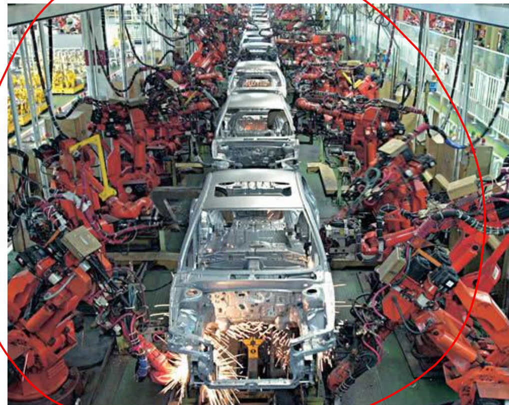
Robôs juntam peças de um futuro automóvel em uma fábrica.
