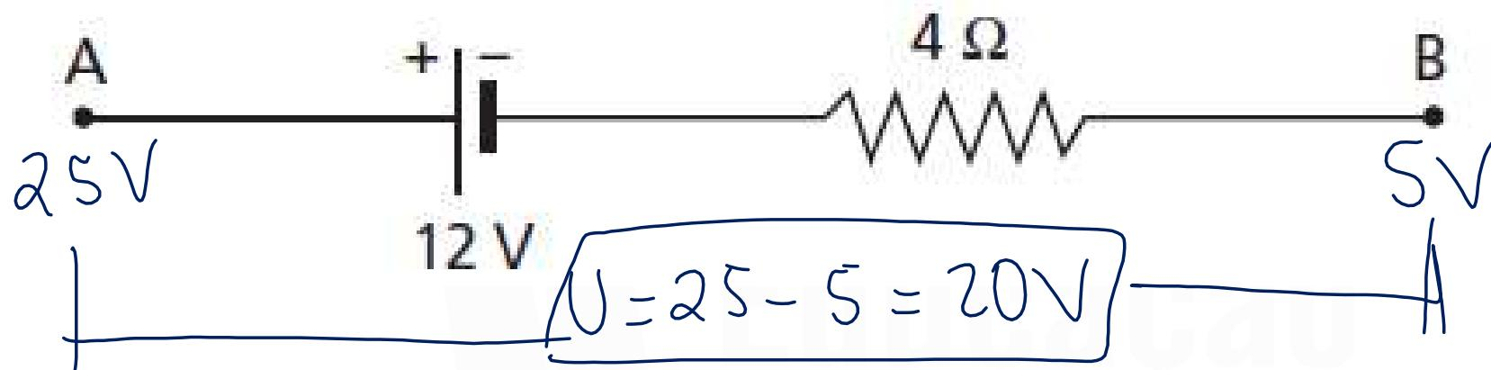
Sabendo que os potenciais em **A** e **B** valem, respectivamente, 25 V e 5 V, calcule a intensidade de corrente nesse elemento, especificando seu sentido.  $\text{V}$
