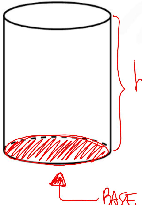
$$V_{CILINDRO} = A_{BASÉ} \times \text{ALTURA}$$
